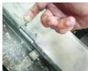
13 juin : La Machine 2 avec Vulcan pour 1 mois, le calcaire a été dissoute et peut être retirée avec le doigt
