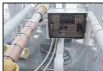
Installation de câbles et le S25 Vulcan dans la boîte.
