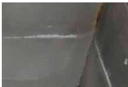
Pic. 1 : Gravé en acier inoxydable après seulement 3 semaines de service, sans utiliser de Vulcan.
